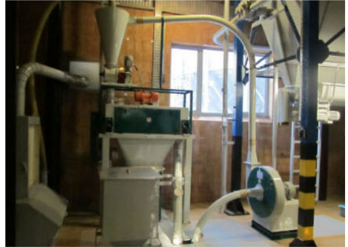
Ventilátoros daráló üzem, vibro szitával
